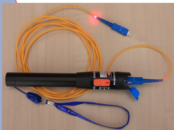
Поврежденный коннектор (излом волокна)
